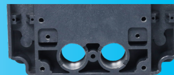
Opción de rosca trasera M20 x 1,5: puede usarse para glándulas de cable adicionales, salida de capilar o salida de sensores de temperatura electrónicos
